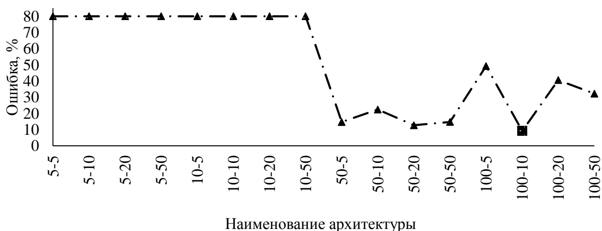
Рис. 4. Зависимость ошибки распознавания от вида архитектуры (количество нейронов в первом и втором слоях полносвязного участка СНС)
